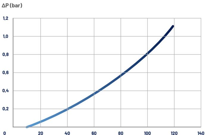
Perdita iniziale tipica di carico, acqua a 20°C, viscosità 1cP
